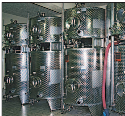
Réalisation avec cuves de stockage et doubles parois ainsi que la superposition.
