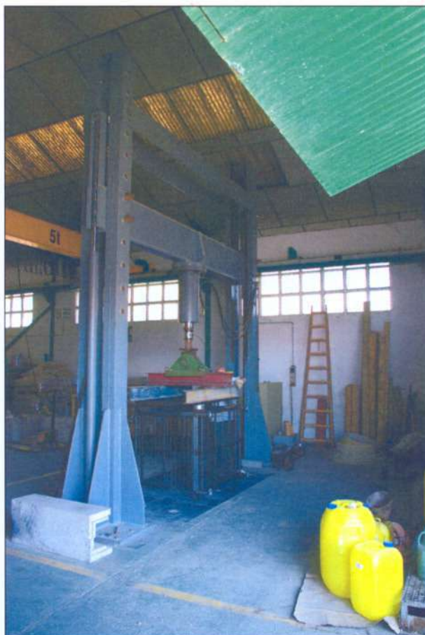
FOTOGRAFÍA N°1: ASPECTO MARCO DE ENSAYO CON CONTENEDOR COLOCADO
