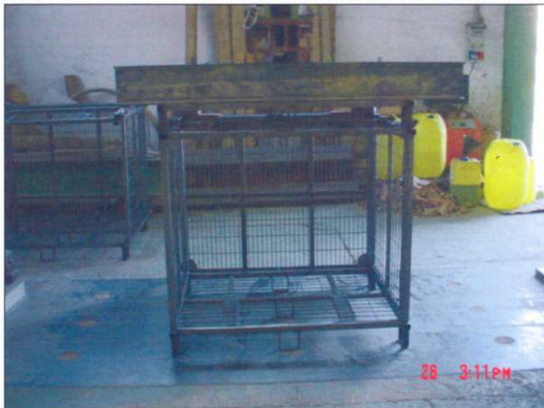
FOTOGRAFÍA Nº8: ASPECTO FRONTAL DEL CONTENEDOR A LA FINALIZACIÓN DE LA PRUEBA (CARGA MAX. ADMISIBLE)
