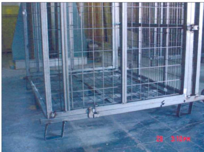
FOTOGRAFÍA N°6 Y N°7: MOMENTO DE FINALIZACIÓN DE LA PRUEBA – DEFORMACIÓN DE PLETINAS DE APOYO
