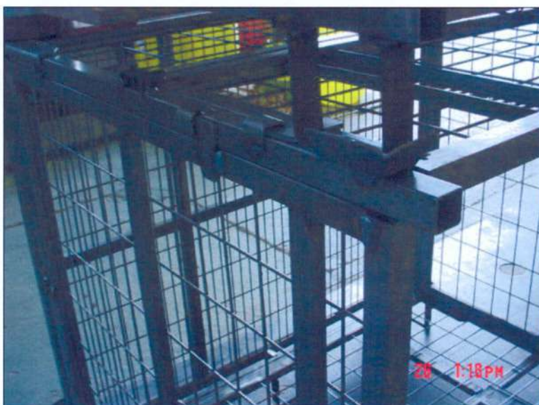
FOTOGRAFÍA N°4 Y N°5: DISPOSITIVO SIMULACIÓN DE APILE Y TRANSMISIÓN DE CARGAS
