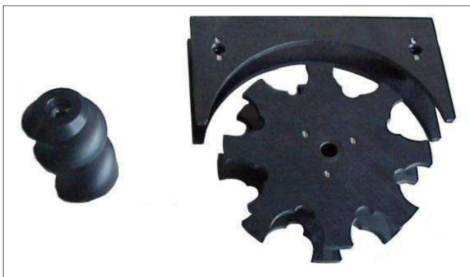
**Sauf exécutions spéciales**, les jeux d'étoiles sont numérotés au diamètre correspondant de la bouteille. Régler également les rails de guidage le long du convoyeur de façon à permettre le libre passage de la bouteille.
