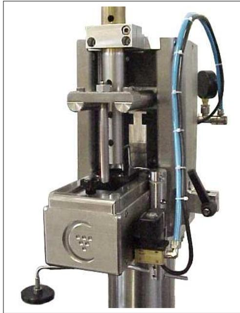
**Remarque:** A l'arrière de la boucheuse il y a un vase de rétention pour éviter à la pompe d'aspirer le trop plein de vin; celui ci doit être vidangé régulièrement, au maximum lorsqu'il est à moitié plein.
