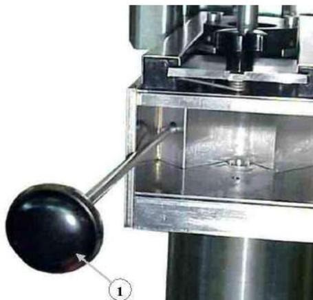
*En mode manuel placer le poinçon en position basse juste au dessus de la tête afin de libérer le Vé mobile de la contre came. Crocheter le mors gauche avec l'outil (1).*
