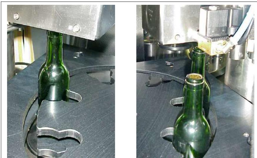
A la boucheuse, la bouteille est reprise par l'étoile à mouvement intermittent, positionné à l'aide de la sellette sous la tête de bouchage, puis c'est l'opération de bouchage (ou capsulage). La bouteille redescend et est emmenée par l'étoile à mouvement intermittent vers le convoyeur de sortie.
