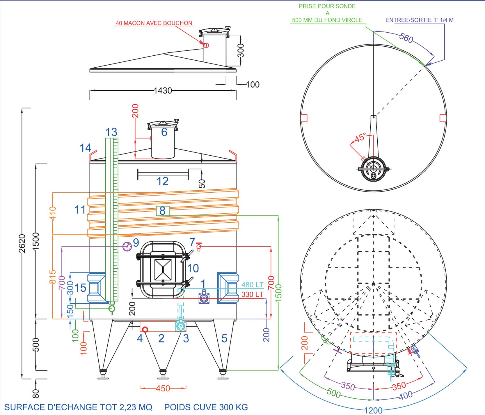
SURFACE D'ECHANGE TOT 2,23 MQ POIDS CUVE 300 KG
