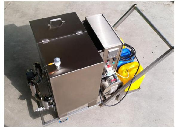
La solution de NEP mobile permet une automatisation complète de votre lavage adaptée à vos besoins. Elle permet le nettoyage des cuves, machines, tuyauteries... Ses systèmes de contrôle apportent sécurité, traçabilité et qualité. Les économies effectuées en terme de consommation d'énergie et de temps, permettent une rentabilité rapide de l'installation.
