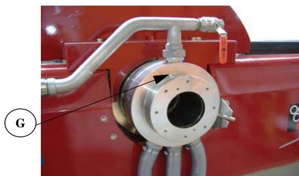
Le collecteur est équipé d'un graisseur **G**. Graisser au début des vendanges avec une graisse alimentaire (le graissage s'effectue pendant la rotation du pressoir).
