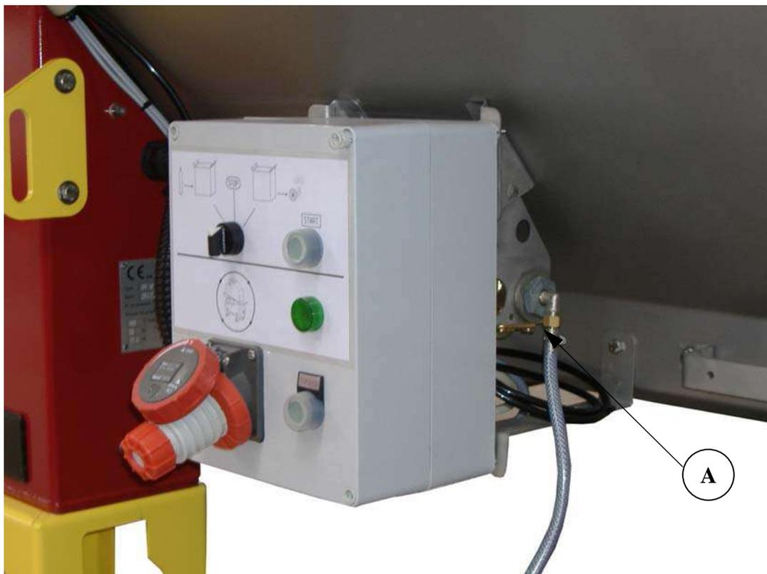
L'alimentation en gaz inerte **A** s'effectue par un raccord situé sur le côté du coffret électrique de commande de la réserve. Ce coffret est situé près de la maie.
