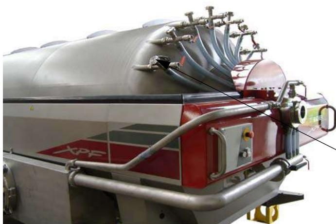
Pour un pressurage standard, il faut démonter les bouchons **B** situés à l'extrémité des drains.
