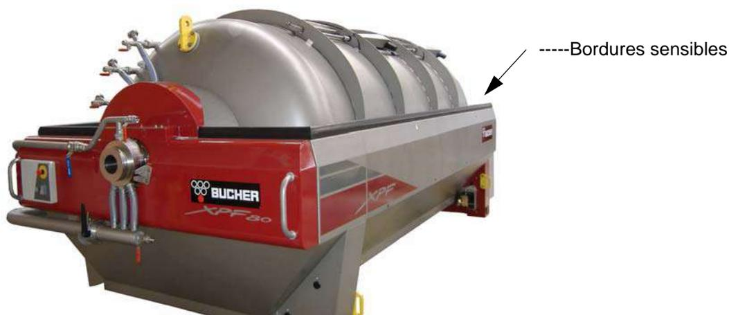
Ces sécurités, placées sur 3 cotés du pressoir, interrompent le fonctionnement du pressoir en cas d'action sur la bordure sensible.
