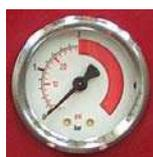
Ce manomètre permet de contrôler la pression de l'air à l'intérieur du presseur
